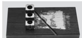
поставьте кулачок на наполнитель и подвигайте взад и вперед с небольшим усилием
