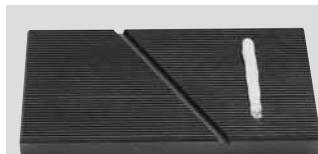
добавьте шлифовальный наполнитель (зерн.320) ближе к краю плиты
