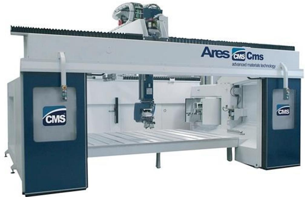
Обработка деталей из ПКМ резание, фрезерование
